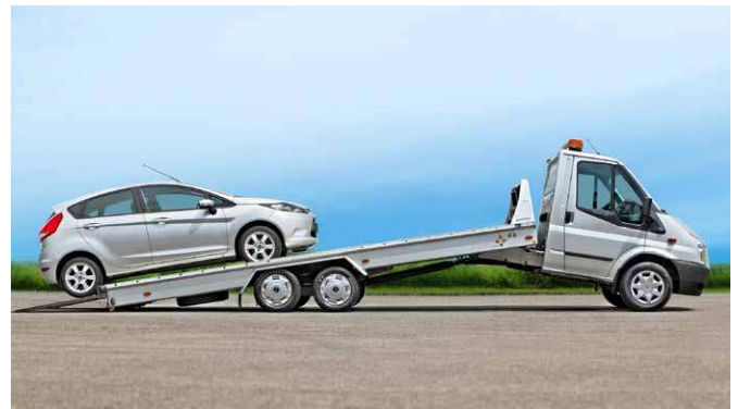
Die einzigartige ALGEMA-Technik: der hydraulische Knick-Mechanismus für schnelles Be- und Entladen.
